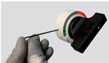
**!** Dans la gamme XL<sup>3</sup>, les commandes rotatives déportées débrayables réf. 4 201 61/74 peuvent se monter uniquement dans une enveloppe XL<sup>3</sup> 4000 équipée d'une porte galbée métal. Pour tout autre type d'enveloppe, le montage est possible si la distance entre la platine (ou le rail) et le plastron (ou la porte) est ≥ 174 mm.
