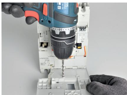
Ouvrir et percer la face avant du disjoncteur (3 trous de diamètre 4 mm) comme indiqué dans la notice.
