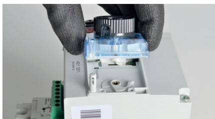
Enlever le bouton rotatif par les 2 vis situées sous la clé de la commande motorisée.
